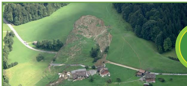
Si le sol n'est pas retenu par un profond réseau racinaire, il glisse facilement en cas de fortes pluies.
