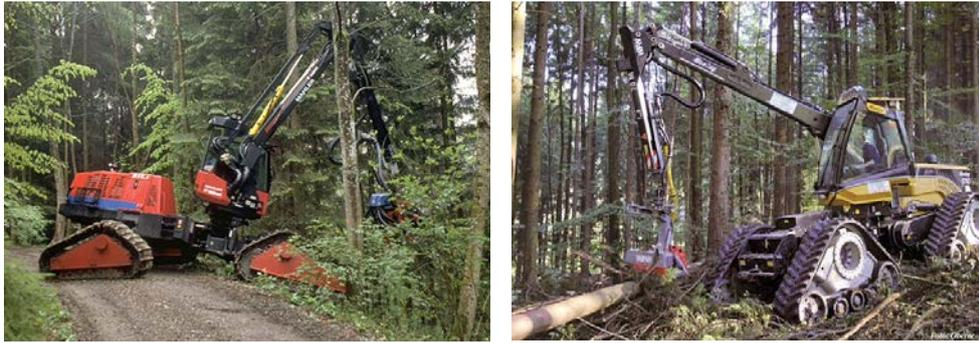
Zur Verminderung der Wurzelschäden wurden verschiedene Alternativen zu Stahlraupen entwickelt, wie Gummiraupen oder Belegung der Stahlraupen mit Kunststoff. Diese Raupensysteme eignen sich jedoch, wie bei den Bogiebändern schon erwähnt, nur für ebenes bis leicht geneigtes Gelände.
