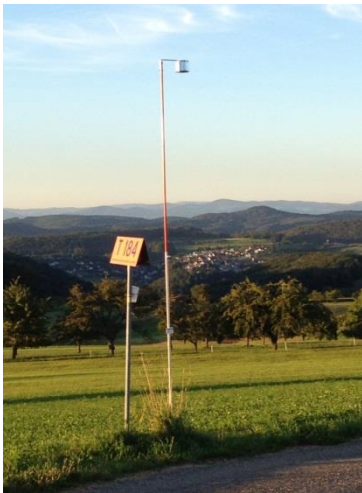
NH 3 -Immissionsmessung mit Passivsammler
